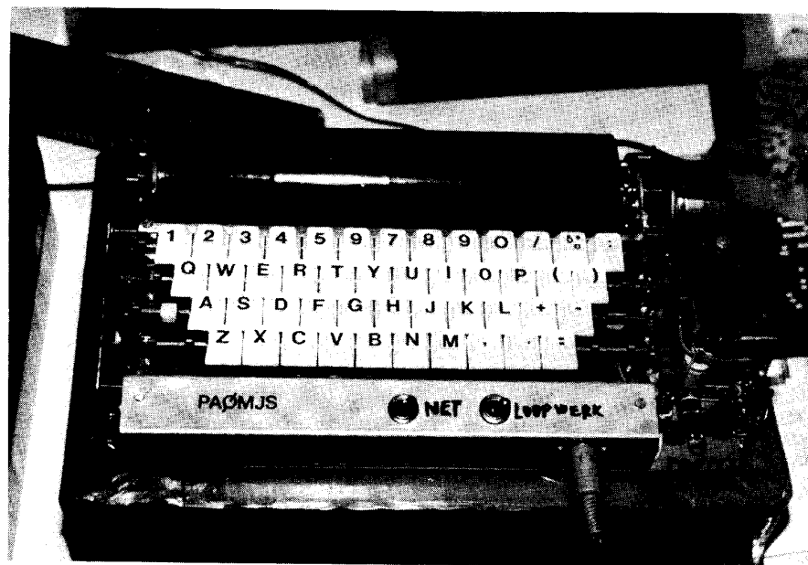
Foto 6. Hellzender van PAoMJS. Achteraan het toestel de codewals waarmee langs elektronische weg de tekens worden gegenereerd. (Foto PAoSE).
